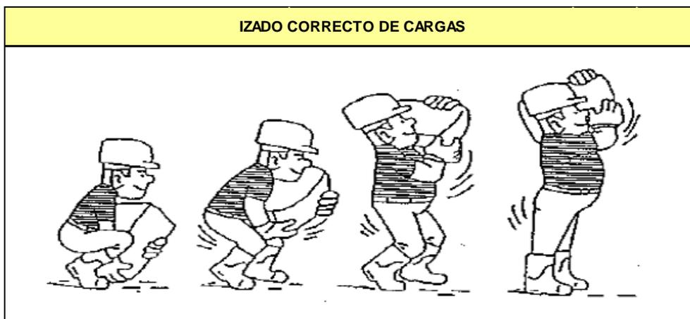
**Figura 13:** Infografía técnica de levantamiento (II).
